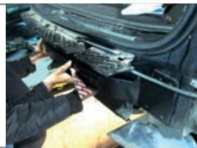
**ШАГ 2.** Установите балку ТСУ, совместив его отверстия со штатными отверстиями крепления усилителя. Поверх кронштейна разместите штатный усилитель и соедините всё с помощью штатных болтов.
