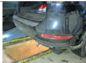
**ШАГ 4.** Установите кронштейн нижний, совместив отверстия в нём с отверстиями в балке ТСУ. Закрепите нижний кронштейн с помощью болтов M12x1,25x120 и гаек M12x1,25 нейлоновых. Установите розетки и зафиксируйте его с помощью гайки M10 через шайбу 10 увеличенную и шайбу 10 гроверную.
